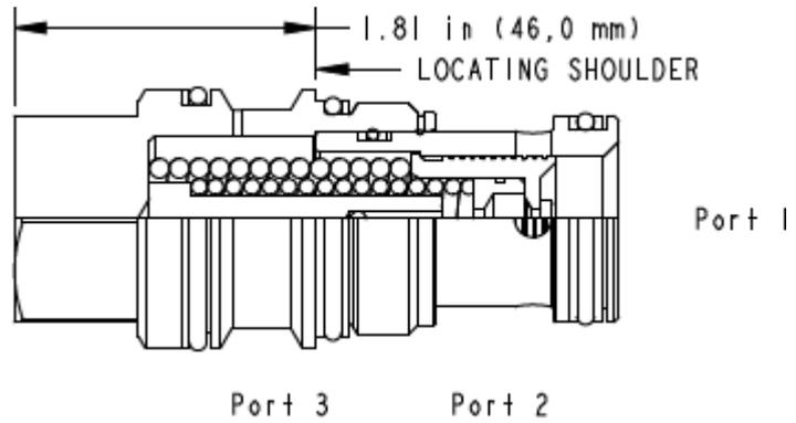
Dieses in Ruhestellung geschlossene Regelement mit interner Verbindung von Anschluss 1 nach 3 kann als Hauptstufe eines Druckbegrenzungsventils eingesetzt werden. Dieses Ventil ist mit einem Vorsteuerdruckbegrenzungs- oder Magnetventil fernsteuerbar.
