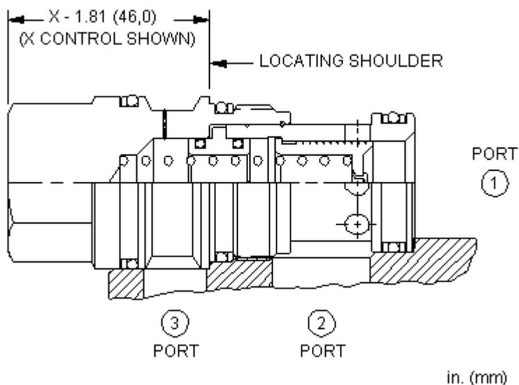
Dieses in Ruhestellung geschlossene Regelement ohne interne Blende hat die Funktion einer 3-Wege-Druckwaage, mit der ein Delta P über eine Blende konstant gehalten wird, unabhängig von Druckschwankungen vor oder nach der Blende.
