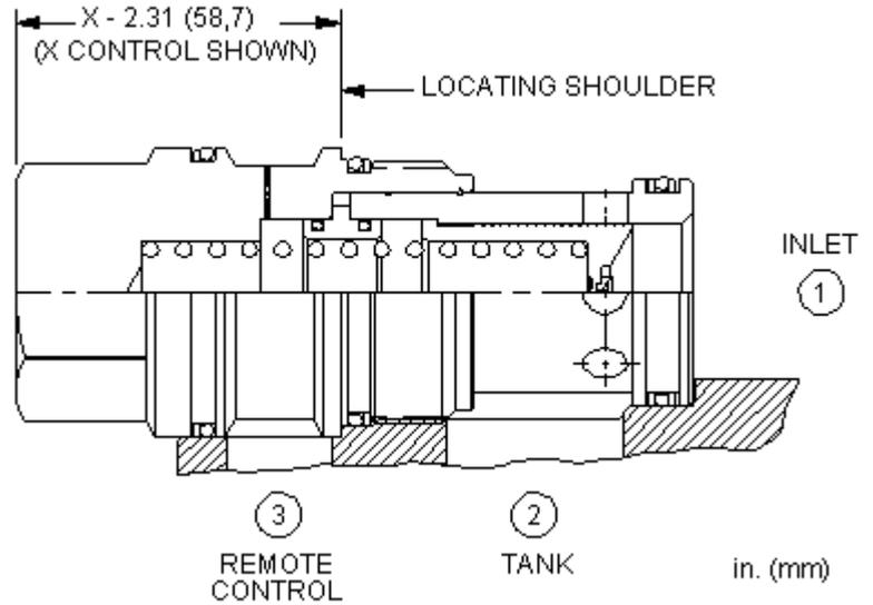
Dieses in Ruhestellung geschlossene Regelement mit interner Verbindung von Anschluss 1 nach 3 kann als Hauptstufe eines Druckbegrenzungsventils eingesetzt werden. Dieses Ventil ist mit einem Vorsteuerdruckbegrenzungs- oder Magnetventil fernsteuerbar.
