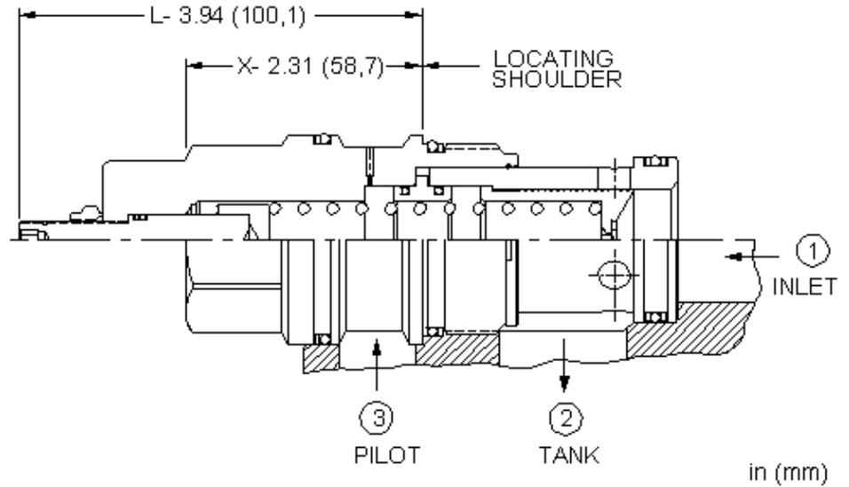
Cet élément de régulation normalement fermé sans gicleur interne est utilisé comme compensateur 3 voies pour maintenir une différence de pression constante à travers un étranglement, quelles que soient les variations de pression en amont ou en aval .
