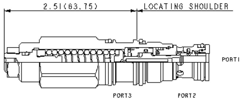
Les valves de contrôle de charge sensibles à la charge avec assistance par pilotage combinent deux valves: un clapet et un limiteur de pression. Le clapet laisse passer librement le débit depuis le distributeur (chambre 2) vers la charge (chambre 1) alors qu'un limiteur à action directe contrôle le débit de la chambre 1 vers la 2. L'assistance par le pilotage à l'orifice 3 abaisse le tarage effectif du limiteur de pression à une valeur déterminée par le rapport de pilotage.
