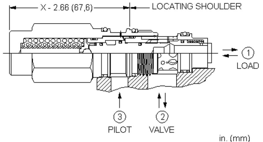
Fest eingestellte Senkbremshalteventile werden bei ziehenden Lasten eingesetzt. Das Rückschlagventil ermöglicht freien Durchfluss von Anschluss 2 nach 1 zum hydraulischen Antrieb und wirkt in Gegenrichtung als ein direktbetätigtes Druckbegrenzungsventil. Steuerdruck an Anschluss 3 beeinflusst den Einstellwert der Druckbegrenzung abhängig vom Aufsteuerverhältnis des Ventils.
