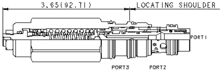
Senkbremschalventile mit Aufsteueranschluss werden bei ziehenden Lasten eingesetzt. Das Rückschlagventil ermöglicht freien Durchfluss von Anschluss 2 nach 1 zum hydraulischen Antrieb und wirkt in Gegenrichtung als ein direktbetätigtes Druckbegrenzungsventil. Steuerdruck an Anschluss 3 verringert den Einstellwert der Druckbegrenzung abhängig vom Aufsteuerverhältnis des Ventils.
