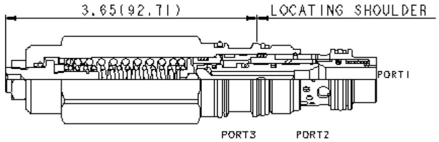
Les valves de contrôle de charge sensibles à la charge avec assistance par pilotage combinent deux valves: un clapet et un limiteur de pression. Le clapet laisse passer librement le débit depuis le distributeur (chambre 2) vers la charge (chambre 1) alors qu'un limiteur à action directe contrôle le débit de la chambre 1 vers la 2. L'assistance par le pilotage à l'orifice 3 abaisse le tarage effectif du limiteur de pression à une valeur déterminée par le rapport de pilotage.
