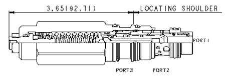
Senkbremshalteventile mit Aufsteueranschluss werden bei ziehenden Lasten eingesetzt. Das Rückschlagventil ermöglicht freien Durchfluss von Anschluss 2 nach 1 zum hydraulischen Antrieb und wirkt in Gegenrichtung als ein direktbetätigtes Druckbegrenzungsventil. Steuerdruck an Anschluss 3 verringert den Einstellwert der Druckbegrenzung abhängig vom Aufsteuerverhältnis des Ventils.
