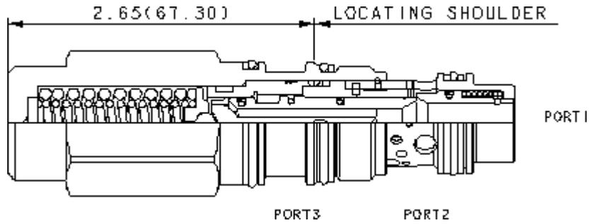
Les valves de contrôle de charge sensibles à la charge, à tarage fixe et avec assistance par pilotage combinent deux valves; un clapet et un limiteur de pression. Le clapet laisse passer librement le débit depuis le distributeur (chambre 2) vers la charge (chambre 1) alors qu'un limiteur à action directe contrôle le débit de la chambre 1 vers la 2. L'assistance par le pilotage à l'orifice 3 abaisse le tarage effectif du limiteur de pression à une valeur déterminée par le rapport de pilotage.
