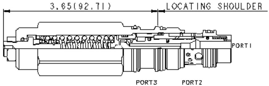
Senkbremschalventile mit Aufsteueranschluss werden bei ziehenden Lasten eingesetzt. Das Rückschlagventil ermöglicht freien Durchfluss von Anschluss 2 nach 1 zum hydraulischen Antrieb und wirkt in Gegenrichtung als ein direktbetätigtes Druckbegrenzungsventil. Steuerdruck an Anschluss 3 verringert den Einstellwert der Druckbegrenzung abhängig vom Aufsteuerverhältnis des Ventils.
