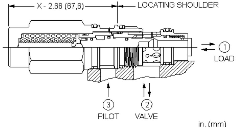
Les valves de contrôle de charge équilibrées combinent un élément modulant équilibré et un clapet. Le clapet laisse passer librement le débit depuis le distributeur (chambre 2) vers la charge (chambre 1) alors que l'élément modulant, lorsqu'il est piloté, ouvre la valve et contrôle le débit de la chambre 1 vers la chambre 2. La pression de pilotage à l'orifice 3 détermine la valeur du débit.
