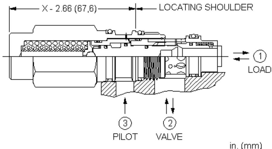
Lastdruckunabhängige Senkbremshalteventile werden bei ziehenden Lasten eingesetzt. Das Rückschlagventil ermöglicht freien Durchfluss von 2 nach 1 zur Last. Der Ablauf in Gegenrichtung erfolgt stromgeregelt. Der Volumenstrom von Anschluss 1 nach 2 verhält sich proportional zum Aufsteuerdruck an Anschluss 3.
