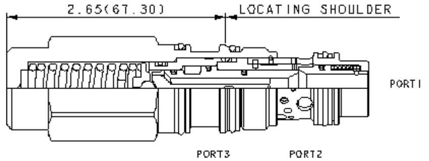
Les valves de contrôle de charge équilibrées combinent un élément modulant équilibré et un clapet. Le clapet laisse passer librement le débit depuis le distributeur (chambre 2) vers la charge (chambre 1) alors que l'élément modulant, lorsqu'il est piloté, ouvre la valve et contrôle le débit de la chambre 1 vers la chambre 2. La pression de pilotage à
