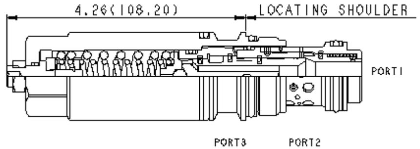
Les valves de contrôle de charge sensibles à la charge avec assistance par pilotage combinent deux valves: un clapet et un limiteur de pression. Le clapet laisse passer librement le débit depuis le distributeur (chambre 2) vers la charge (chambre 1) alors qu'un limiteur à action directe contrôle le débit de la chambre 1 vers la 2. L'assistance par le pilotage à l'orifice 3 abaisse le tarage effectif du limiteur de pression à une valeur déterminée par le rapport de pilotage.
