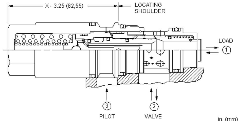
Fest eingestellte Senkbremshalteventile werden bei ziehenden Lasten eingesetzt. Das Rückschlagventil ermöglicht freien Durchfluss von Anschluss 2 nach 1 zum hydraulischen Antrieb und wirkt in Gegenrichtung als ein direktbetätigtes Druckbegrenzungsventil. Steuerdruck an Anschluss 3 beeinflusst den Einstellwert der Druckbegrenzung abhängig vom Aufsteuerverhältnis des Ventils.
