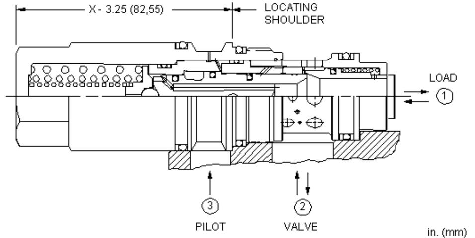
Fest eingestellte Senkbremshalteventile werden bei ziehenden Lasten eingesetzt. Das Rückschlagventil ermöglicht freien Durchfluss von Anschluss 2 nach 1 zum hydraulischen Antrieb und wirkt in Gegenrichtung als ein direktbetätigtes Druckbegrenzungsventil. Steuerdruck an Anschluss 3 beeinflusst den Einstellwert der Druckbegrenzung abhängig vom Aufsteuerverhältnis des Ventils.
