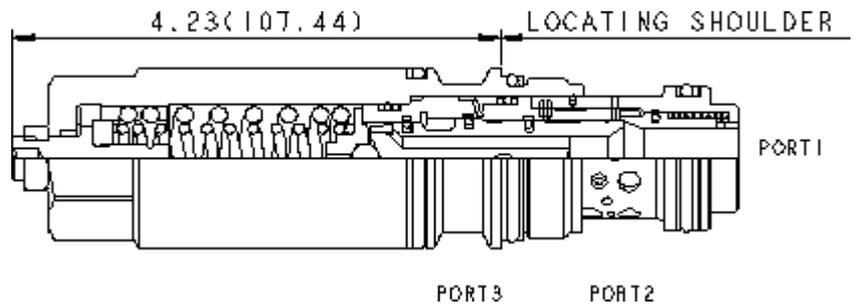
Senkbremshalventile mit Aufsteueranschluss werden bei ziehenden Lasten eingesetzt. Das Rückschlagventil ermöglicht freien Durchfluss von Anschluss 2 nach 1 zum hydraulischen Antrieb und wirkt in Gegenrichtung als ein direktbetätigtes Druckbegrenzungsventil. Steuerdruck an Anschluss 3 verringert den Einstellwert der Druckbegrenzung abhängig vom Aufsteuerverhältnis des Ventils.
