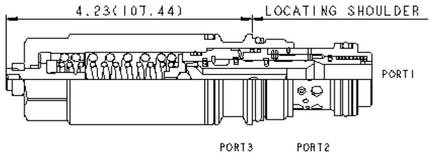
Les valves de contrôle de charge sensibles à la charge avec assistance par pilotage combinent deux valves: un clapet et un limiteur de pression. Le clapet laisse passer librement le débit depuis le distributeur (chambre 2) vers la charge (chambre 1) alors qu'un limiteur à action directe contrôle le débit de la chambre 1 vers la 2. L'assistance par le pilotage à l'orifice 3 abaisse le tarage effectif du limiteur de pression à une valeur déterminée par le rapport de pilotage.
