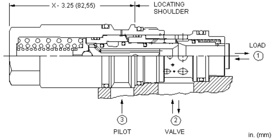
Les valves de contrôle de charge sensibles à la charge, à tarage fixe et avec assistance par pilotage combinent deux valves; un clapet et un limiteur de pression. Le clapet laisse passer librement le débit depuis le distributeur (chambre 2) vers la charge (chambre 1) alors qu'un limiteur à action directe contrôle le débit de la chambre 1 vers la 2. L'assistance par le pilotage à l'orifice 3 abaisse le tarage effectif du limiteur de pression à une valeur déterminée par le rapport de pilotage.
