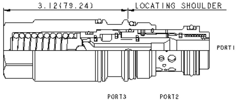
Lastdruckunabhängige Senkbremshalteventile werden bei ziehenden Lasten eingesetzt. Das Rückschlagventil ermöglicht freien Durchfluss von 2 nach 1 zur Last. Der Ablauf in Gegenrichtung erfolgt stromgeregelt. Der Volumenstrom von Anschluss 1 nach 2 verhält sich proportional zum Aufsteuerdruck an Anschluss 3.
