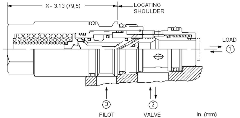
Lastdruckunabhängige Senkbremshalteventile werden bei ziehenden Lasten eingesetzt. Das Rückschlagventil ermöglicht freien Durchfluss von 2 nach 1 zur Last. Der Ablauf in Gegenrichtung erfolgt stromgeregelt. Der Volumenstrom von Anschluss 1 nach 2 verhält sich proportional zum Aufsteuerdruck an Anschluss 3.
