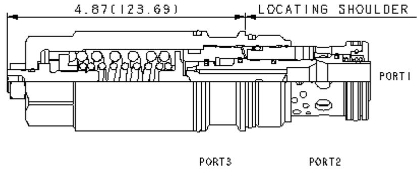
Senkbremshalventile mit Aufsteueranschluss werden bei ziehenden Lasten eingesetzt. Das Rückschlagventil ermöglicht freien Durchfluss von Anschluss 2 nach 1 zum hydraulischen Antrieb und wirkt in Gegenrichtung als ein direktbetätigtes Druckbegrenzungsventil. Steuerdruck an Anschluss 3 verringert den Einstellwert der Druckbegrenzung abhängig vom Aufsteuerverhältnis des Ventils.
