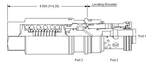
Fest eingestellte Senkbremshalteventile werden bei ziehenden Lasten eingesetzt. Das Rückschlagventil ermöglicht freien Durchfluss von Anschluss 2 nach 1 zum hydraulischen Antrieb und wirkt in Gegenrichtung als ein direktbetätigtes Druckbegrenzungsventil. Steuerdruck an Anschluss 3 beeinflusst den Einstellwert der Druckbegrenzung abhängig vom Aufsteuerverhältnis des Ventils.
