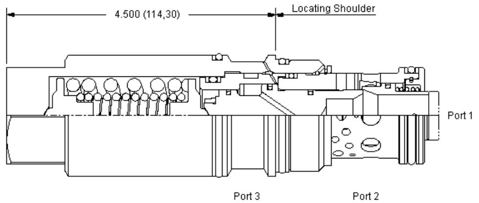
Les valves de contrôle de charge sensibles à la charge, à tarage fixe et avec assistance par pilotage combinent deux valves; un clapet et un limiteur de pression. Le clapet laisse passer librement le débit depuis le distributeur (chambre 2) vers la charge (chambre 1) alors qu'un limiteur à action directe contrôle le débit de la chambre 1 vers la 2. L'assistance par le pilotage à l'orifice 3 abaisse le tarage effectif du limiteur de pression à une valeur déterminée par le rapport de pilotage.
