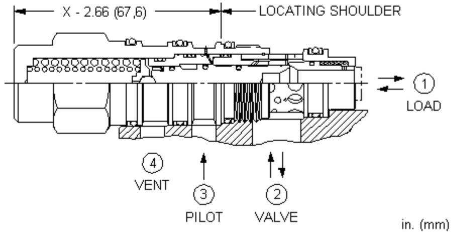
Entlastete, lastdruckunabhängige Senkbremshalteventile werden bei ziehenden Lasten eingesetzt. Das Rückschlagventil ermöglicht freien Durchfluss von Anschluss 2 nach 1 zur Last. Der Ablauf in Gegenrichtung erfolgt stromgeregelt. Der Volumenstrom von Anschluss 1 nach 2 verhält sich proportional zum Aufsteuerdruck an Anschluss 3. Anschluss 4 ermöglicht externe Entlastung des Federraums bei Gegendruck an Anschluss 2.
