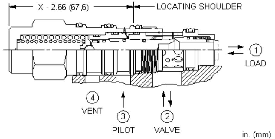
Entlastete, lastdruckunabhängige Senkbremshalteventile werden bei ziehenden Lasten eingesetzt. Das Rückschlagventil ermöglicht freien Durchfluss von Anschluss 2 nach 1 zur Last. Der Ablauf in Gegenrichtung erfolgt stromgeregelt. Der Volumenstrom von Anschluss 1 nach 2 verhält sich proportional zum Aufsteuerdruck an Anschluss 3. Anschluss 4 ermöglicht externe Entlastung des Federraums bei Gegendruck an Anschluss 2.
