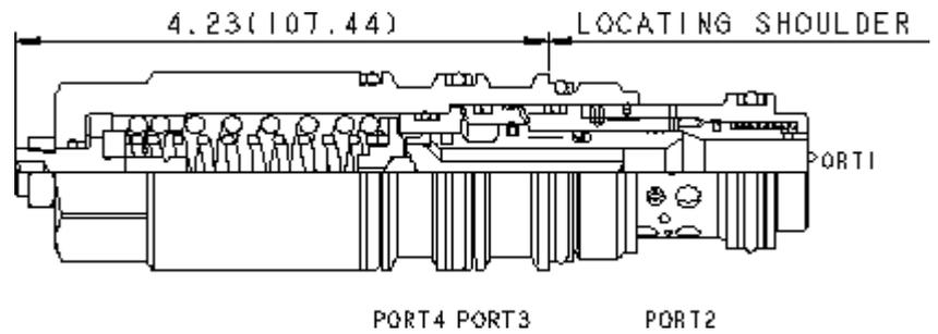
Senkbremshalventile mit Aufsteueranschluss werden bei ziehenden Lasten eingesetzt. Das Rückschlagventil ermöglicht freien Durchfluss von Anschluss 2 nach 1 zum hydraulischen Antrieb und wirkt in Gegenrichtung als ein direktbetätigtes Druckbegrenzungsventil. Steuerdruck an Anschluss 3 verringert den Einstellwert der Druckbegrenzung abhängig vom Aufsteuerverhältnis des Ventils. Staudruck an Anschluss 2 hat keinen Einfluss auf die Ventileinstellung, da der Federraum über Anschluss 4 entlastet ist.
