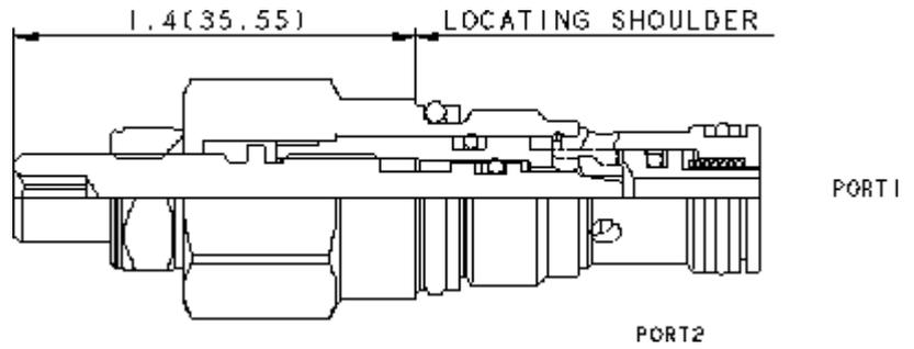
Les étrangleurs à pointeau unidirectionnels sont des orifices réglables utilisés pour réguler le débit. Ils permettent une infinité de réglages depuis la fermeture complètement étanche jusqu'au diamètre maximum de l'orifice. Un clapet intégral de grande capacité laisse passer le débit sans restriction de la chambre 2 vers la chambre 1. Ils ne sont pas compensés en pression.
