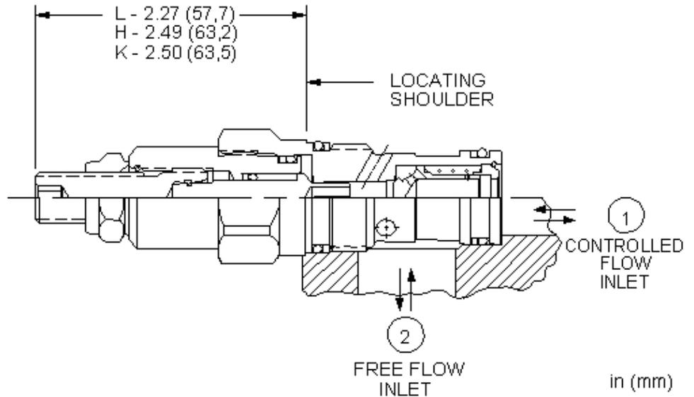
Die voll verstellbare Blende ermöglicht das feinfühliges Dosieren von Volumenströmen. Das integrierte Umgehungsrückschlagventil öffnet von Anschluss 2 nach 1. Der Einstellbereich reicht von vollständig geschlossen stufenlos bis zum maximalen Blendendurchmesser. Der Volumenstrom ist abhängig vom Druckabfall. Das Ventil kann als Strom- und/oder Sperrventil eingesetzt werden.
