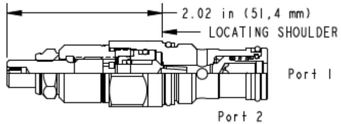
Les étrangleurs à pointe unidirectionnels sont des orifices réglables utilisés pour réguler le débit. Ils permettent une infinité de réglages depuis la fermeture complètement étanche jusqu'au diamètre maximum de l'orifice. Un clapet intégral de grande capacité laisse passer le débit sans restriction de la chambre 2 vers la chambre 1. Ils ne sont pas compensés en pression.
