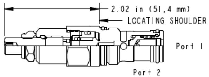
Les étrangleurs à pointeau unidirectionnels sont des orifices réglables utilisés pour réguler le débit. Ils permettent une infinité de réglages depuis la fermeture complètement étanche jusqu'au diamètre maximum de l'orifice. Un clapet intégral de grande capacité laisse passer le débit sans restriction de la chambre 2 vers la chambre 1. Ils ne sont pas compensés en pression.
