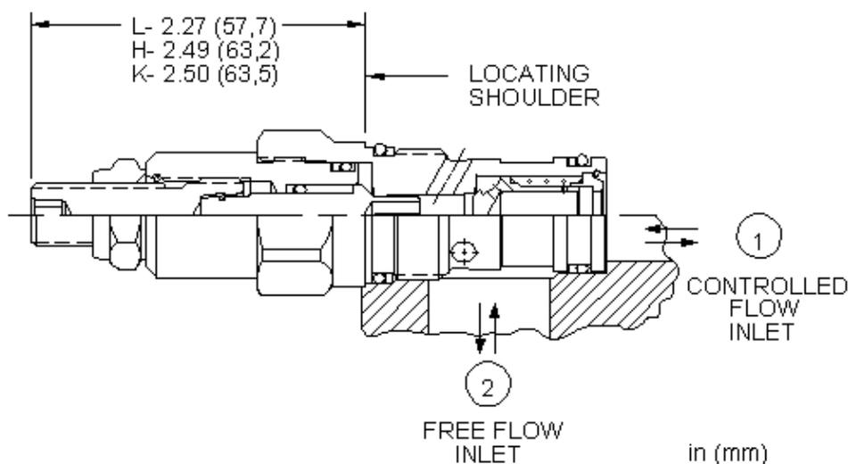
Les étrangleurs à pointeau unidirectionnels sont des orifices réglables utilisés pour réguler le débit. Ils permettent une infinité de réglages depuis la fermeture complètement étanche jusqu'au diamètre maximum de l'orifice. Un clapet intégral de grande capacité laisse passer le débit sans restriction de la chambre 2 vers la chambre 1. Ils ne sont pas compensés en pression.
