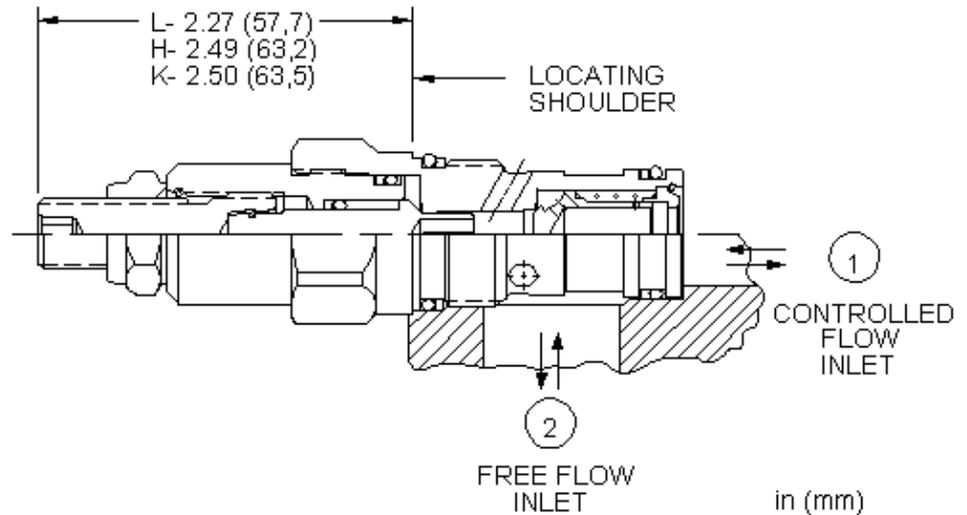
Les étrangleurs à pointeau unidirectionnels sont des orifices réglables utilisés pour réguler le débit. Ils permettent une infinité de réglages depuis la fermeture complètement étanche jusqu'au diamètre maximum de l'orifice. Un clapet intégral de grande capacité laisse passer le débit sans restriction de la chambre 2 vers la chambre 1. Ils ne sont pas compensés en pression.
