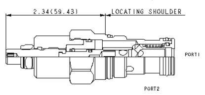
Les étrangleurs à pointeau unidirectionnels sont des orifices réglables utilisés pour réguler le débit. Ils permettent une infinité de réglages depuis la fermeture complètement étanche jusqu'au diamètre maximum de l'orifice. Un clapet intégral de grande capacité laisse passer le débit sans restriction de la chambre 2 vers la chambre 1. Ils ne sont pas compensés en pression.
