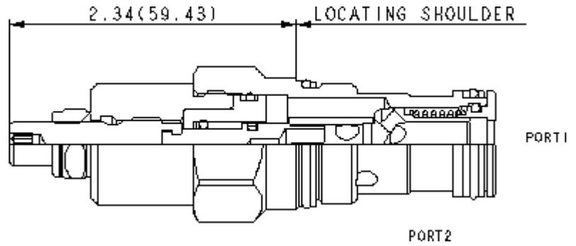
Les étrangleurs à pointeau unidirectionnels sont des orifices réglables utilisés pour réguler le débit. Ils permettent une infinité de réglages depuis la fermeture complètement étanche jusqu'au diamètre maximum de l'orifice. Un clapet intégral de grande capacité laisse passer le débit sans restriction de la chambre 2 vers la chambre 1. Ils ne sont pas compensés en pression.
