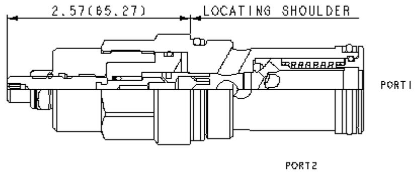
Les étrangleurs à pointe unidirectionnels sont des orifices réglables utilisés pour réguler le débit. Ils permettent une infinité de réglages depuis la fermeture complètement étanche jusqu'au diamètre maximum de l'orifice. Un clapet intégral de grande capacité laisse passer le débit sans restriction de la chambre 2 vers la chambre 1. Ils ne sont pas compensés en pression.
