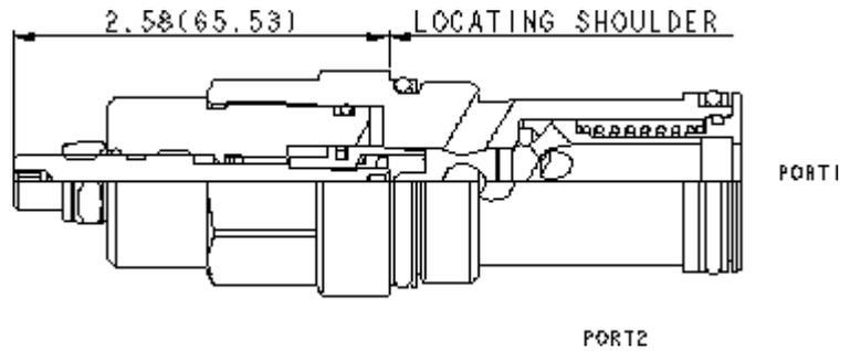
Les étrangleurs à pointeau unidirectionnels sont des orifices réglables utilisés pour réguler le débit. Ils permettent une infinité de réglages depuis la fermeture complètement étanche jusqu'au diamètre maximum de l'orifice. Un clapet intégral de grande capacité laisse passer le débit sans restriction de la chambre 2 vers la chambre 1. Ils ne sont pas compensés en pression.
