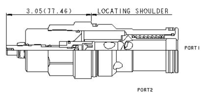
Les étrangleurs à pointeau unidirectionnels sont des orifices réglables utilisés pour réguler le débit. Ils permettent une infinité de réglages depuis la fermeture complètement étanche jusqu'au diamètre maximum de l'orifice. Un clapet intégral de grande capacité laisse passer le débit sans restriction de la chambre 2 vers la chambre 1. Ils ne sont pas compensés en pression.
