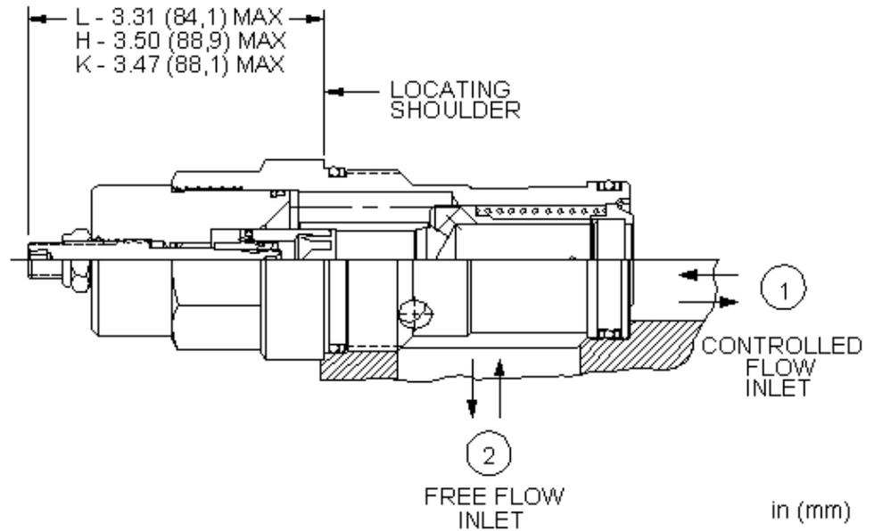
Die voll verstellbare Blende ermöglicht das feinfühliges Dosieren von Volumenströmen. Das integrierte Umgehungsrückschlagventil öffnet von Anschluss 2 nach 1. Der Einstellbereich reicht von vollständig geschlossen stufenlos bis zum maximalen Blendendurchmesser. Der Volumenstrom ist abhängig vom Druckabfall. Das Ventil kann als Strom- und/oder Sperrventil eingesetzt werden.
