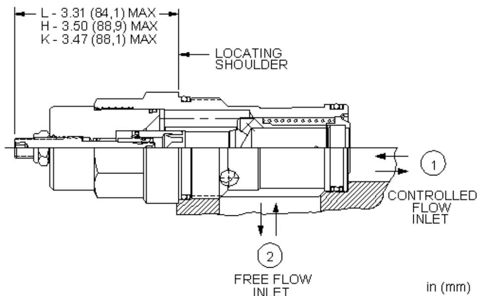
Les étrangleurs à poiteau unidirectionnels sont des orifices réglables utilisés pour réguler le débit. Ils permettent une infinité de réglages depuis la fermeture complètement étanche jusqu'au diamètre maximum de l'orifice. Un clapet intégral de grande capacité laisse passer le débit sans restriction de la chambre 2 vers la chambre 1. Ils ne sont pas compensés en pression.
