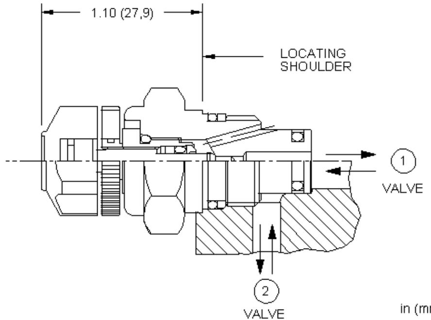
Feindrosselventile für kleine Volumenströme in Vorsteueranwendungen sind voll verstellbar und einsetzbar in Zulauf- oder Ablaufsteuerungen. Das Ventil nutzt das T-8A Bohrkonzzept und eignet sich als Vorsteuerventil in Hauptstufenventilen von SUN.
