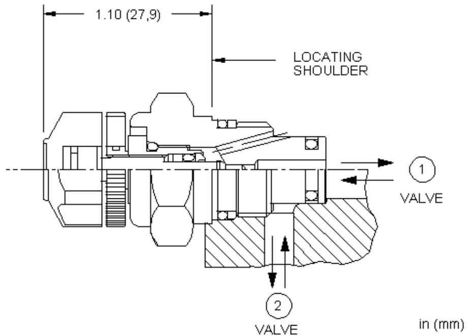
Les étages pilotes étrangleurs de débit à 2 voies, sont des cartouches réglables utilisées pour réguler le débit dans un étage principal ou dans les applications où l'on doit réguler un faible débit bidirectionnel. Ces cartouches se montent dans une cavité Sun T-8A ce qui en fait le choix idéal pour piloter les cartouches d'étage de puissance Sun.
