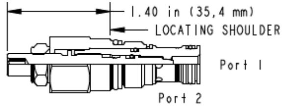
Die voll verstellbare Blende ermöglicht das feinfühliges Dosieren von Volumenströmen. Der Einstellbereich reicht von vollständig geschlossen stufenlos bis zum maximalen Blendendurchmesser. Der Volumenstrom ist abhängig vom Druckabfall. Das Ventil kann als Strom- und/oder Sperrventil eingesetzt werden.
