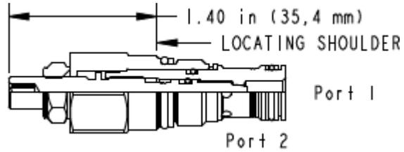
Les étrangleurs à pointeau bidirectionnels sont des orifices réglables utilisés pour réguler le débit. Ils permettent une infinité de réglages depuis la fermeture complètement étanche jusqu'au diamètre maximum de l'orifice. Ils ne sont pas compensés en pression. Ils peuvent être utilisés pour contrôler un débit ou comme un simple robinet ouvert ou fermé.
