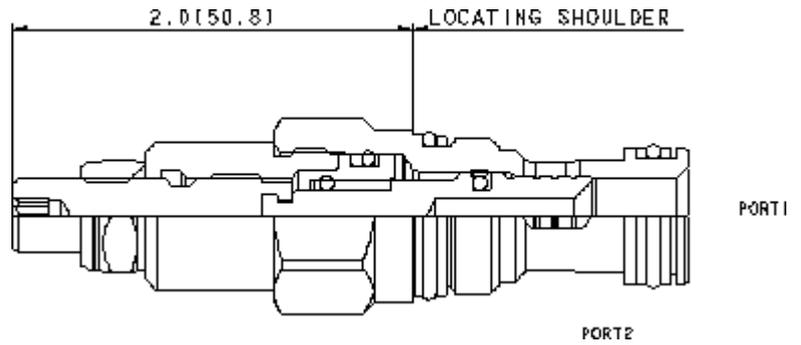
Die voll verstellbare Blende ermöglicht das feinfühliges Dosieren von Volumenströmen. Der Einstellbereich reicht von vollständig geschlossen stufenlos bis zum maximalen Blendendurchmesser. Der Volumenstrom ist abhängig vom Druckabfall. Das Ventil kann als Strom- und/oder Sperrventil eingesetzt werden.
