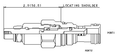
Die voll verstellbare Blende ermöglicht das feinfühlige Dosieren von Volumenströmen. Der Einstellbereich reicht von vollständig geschlossen stufenlos bis zum maximalen Blendendurchmesser. Der Volumenstrom ist abhängig vom Druckabfall. Das Ventil kann als Strom- und/oder Sperrventil eingesetzt werden.
