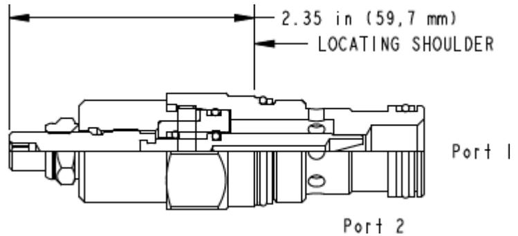
Die voll verstellbare Blende ermöglicht das feinfühliges Dosieren von Volumenströmen. Der Einstellbereich reicht von vollständig geschlossen stufenlos bis zum maximalen Blendendurchmesser. Der Volumenstrom ist abhängig vom Druckabfall. Das Ventil kann als Strom- und/oder Sperrventil eingesetzt werden.
