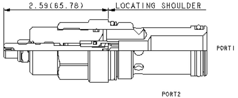
Les étrangleurs à pointeau bidirectionnels sont des orifices réglables utilisés pour réguler le débit. Ils permettent une infinité de réglages depuis la fermeture complètement étanche jusqu'au diamètre maximum de l'orifice. Ils ne sont pas compensés en pression. Ils peuvent être utilisés pour contrôler un débit ou comme un simple robinet ouvert ou fermé.
