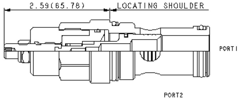
Die voll verstellbare Blende ermöglicht das feinfühliges Dosieren von Volumenströmen. Der Einstellbereich reicht von vollständig geschlossen stufenlos bis zum maximalen Blendendurchmesser. Der Volumenstrom ist abhängig vom Druckabfall. Das Ventil kann als Strom- und/oder Sperrventil eingesetzt werden.
